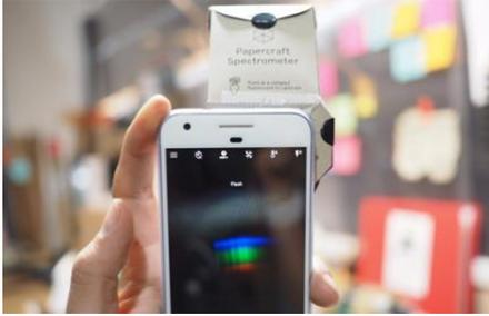
Les objectifs de l'évolution du spectromètre papier étaient : le rendre plus rigide / robuste, imprimable sur du papier non noir / plus facile à découper avec juste des ciseaux / mettre plus d'instructions sur l'objet lui-même.
